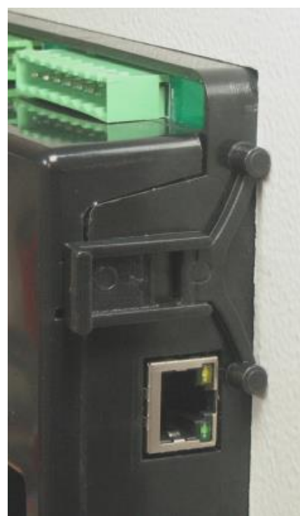
Instalação do suporte do tipo autorretenção
