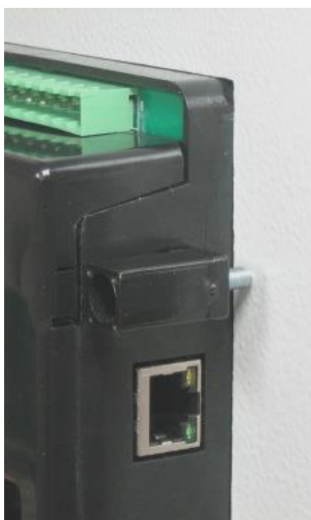
Instalação do suporte do tipo parafuso
