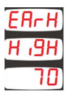
Bu parametre toprak kaçak için toprak geriliminin giriş gerilimine oranının üst limitini ayarlar.
